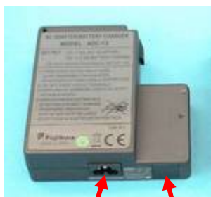
Entrée AC Entrée DC
